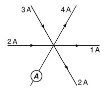
What is the reading of ammeter A?A) 1 AB) 2 AC) 3 AD) 4 A
